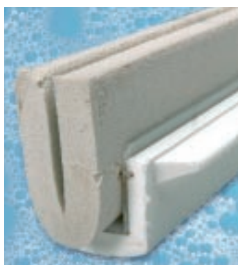
Gąbczasta guma jest zużyta; robi się miękka i porowata. Gdy do tego dochodzi, wyrób powinien zostać wymieniony.
