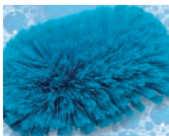
Włosie jest splątane w wyniku długotrwałego użytkowania – wyrób powinien zostać wymieniony.
